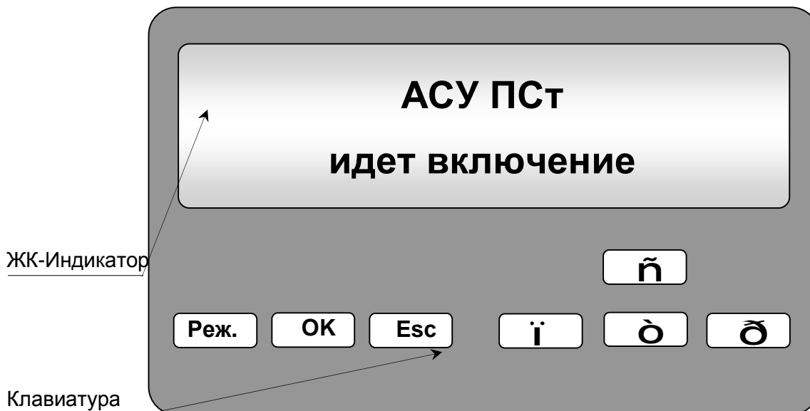
Рисунок 3 – Внешний вид панели управления шкафа электроники
