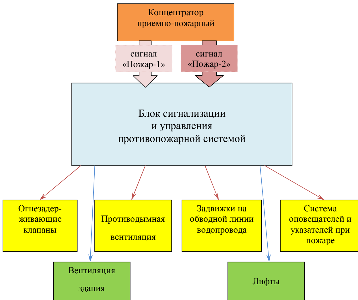
Рисунок 1 - Функциональная схема включения БСУПС в противопожарную систему
